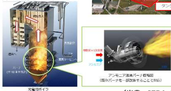
参考2: ボイラおよび燃焼バーナの概略
